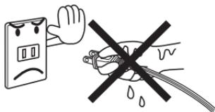
電源プラグを抜くときは、電源コードを持たずに電源プラグを持って抜いてください。
