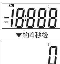
「入／切」ボタンに触れて電源を入れます。同時にバックライトが点灯します。(約8秒間)
