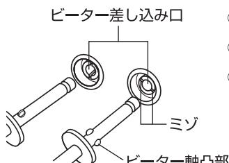
ビーター軸凸部をビーター差し込み口のミゾに合わせ、カチッと音がして止まるまでしっかりと差し込んでください。
