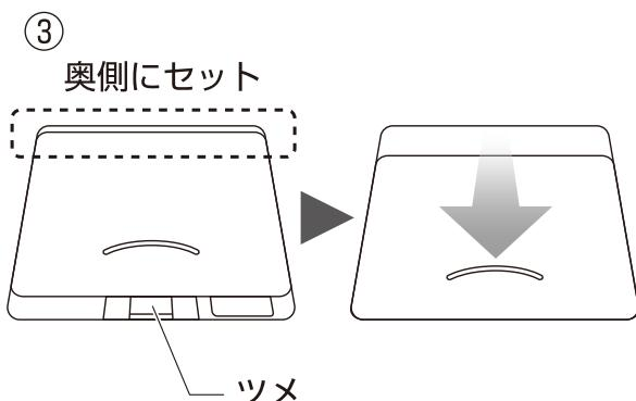
③ 電池カバーを奥側にセットし、パチッと音がするまで手前にスライドさせて閉じます。
