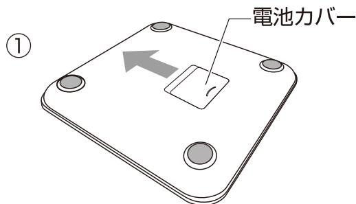
① 本体裏側の電池カバーを矢印方向へスライドさせて取りはずします。
