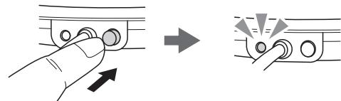
※約 4 時間経過すると LED ランプが点灯から点滅に変わり、自動的に加熱が停止します。
