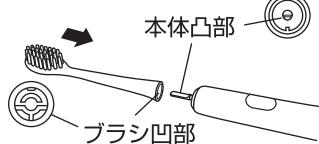
※ブラシの凹部と本体の凸部を図のように合わせて差し込みます。
